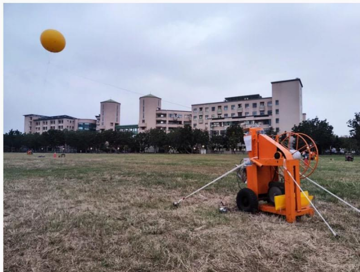
高雄大學師生以纜繩繫縛並控制空飄氣球移動的捲揚機。圖／高雄大學提供
